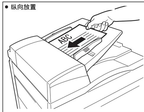
**1** 请将原稿导板对齐原稿尺寸刻度。
